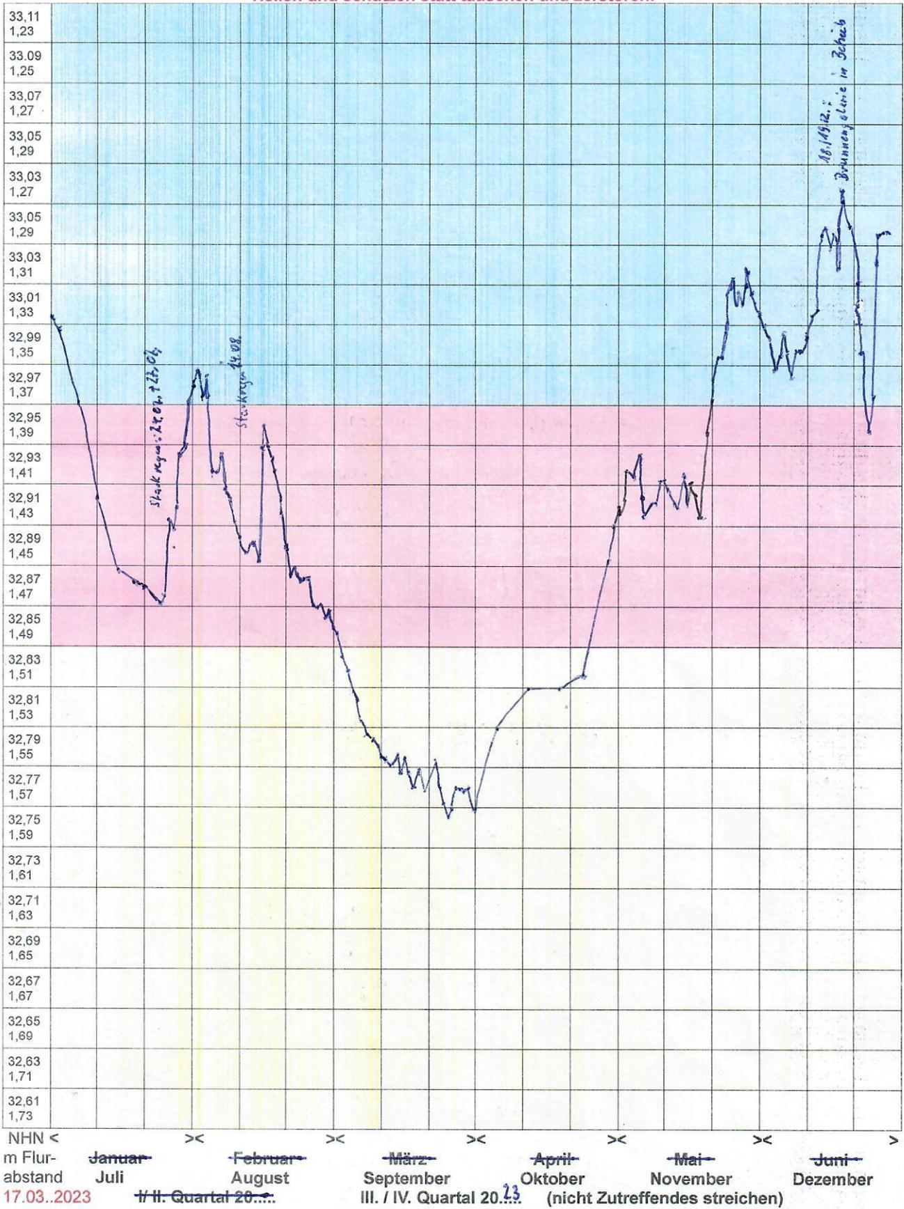
Fundamentsohle: 32,42 | Bodenplatte Unterkante: 32,83 | Bodenplatteoberkante (Kellerfußboden): 32,95
